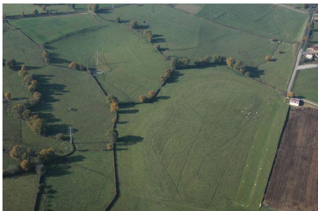
Figure 6 Exemple de champs drainés
